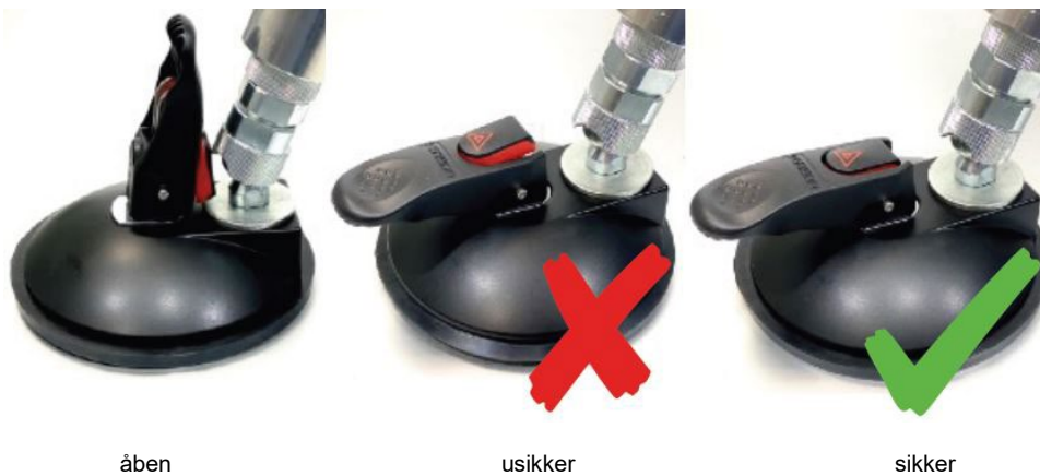
Sugekop med vakuuminikator Billede 16
